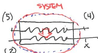
$$\frac{dE}{dt} = \dot{Q} + \dot{W} + \dot{m}(h_2) + \dot{m}(h_4) - \dot{m} h_x - \dot{m} h_5$$
