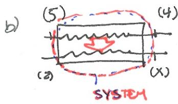
$$\frac{dS_{\text{gen}}}{dt} = \frac{\dot{Q}}{T_b} + \dot{m}(D_2) + \dot{m}_1 D_4 - \dot{m} D_x - \dot{m} D_5 + \dot{S}_{\text{gen}}$$
