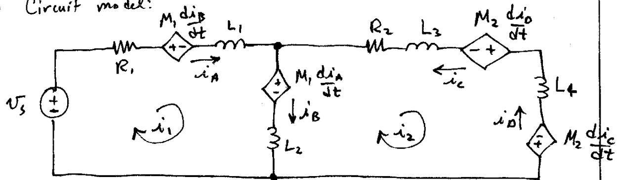
$$\#1: -V_s + R_1 i_1 + M_1 \frac{di_B}{dt} + L_1 \frac{di_1}{dt} + M_1 \frac{di_A}{dt} + L_2 \left( \frac{i_1 - i_2}{dt} \right) = 0$$
